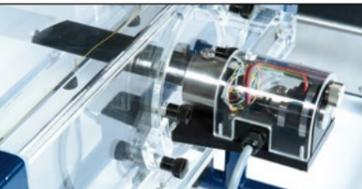
**Waage für Auftrieb und Widerstand - C15-13** (erfordert C15-20 oder C15-22)
