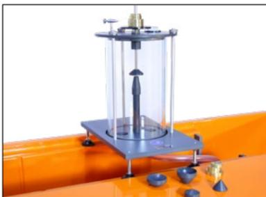
**Aufprall eines Strahls - F1-16**
