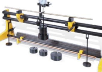
**Torsions- und Biegeprüfmaschine - SD-4.00**
