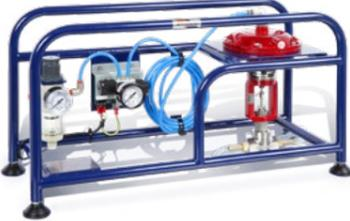
**Pneumatisches Ventilmodul-Zubehör - PCT44**
