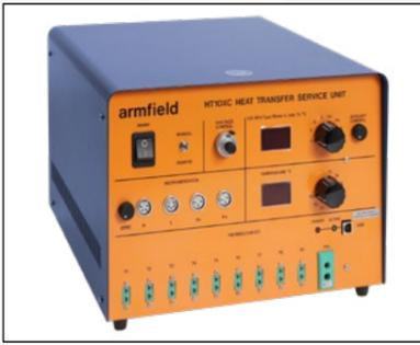
**Computergesteuertes Wärmeübertragungs-Lehrgerät - HT10XC**
