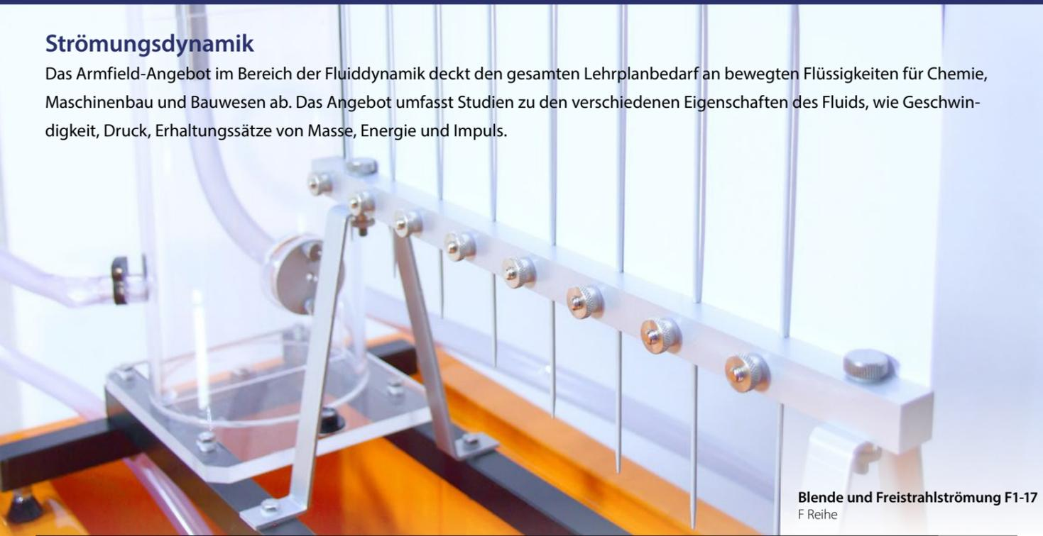
Blende und Freistrahldströmung F1-17
