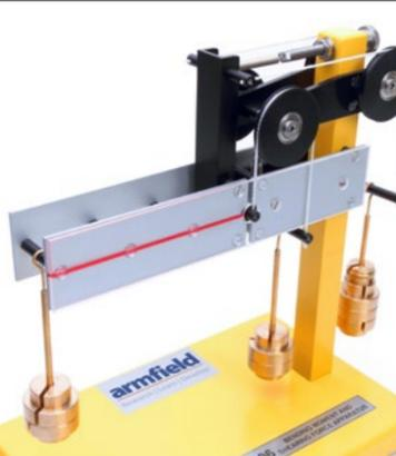
**Biegemoment- und Scherkraftgerät - DT-8.06**
