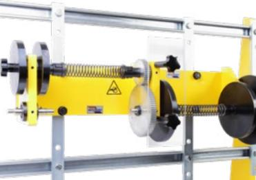
**Gerät für Torsionsschwingungen - SD-4.14**
