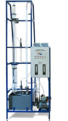
**Gasabsorptionssäule mit benetzter Wand - CES**
