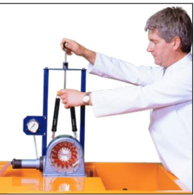
**Reihen- und Parallelschaltung von Pumpen - F1-35**
