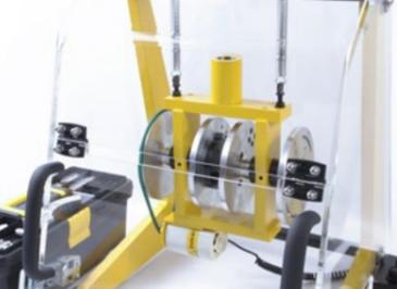
**Statischer und dynamischer Auswuchtapparat - SD-1.23**
