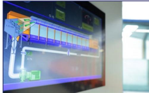
**PLC-Kanal-Steuerungssystem mit berührungsempfindlichem Bildschirm**
