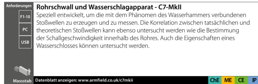
**Rohrschwall und Wasserschlagapparat - C7-MkII**
