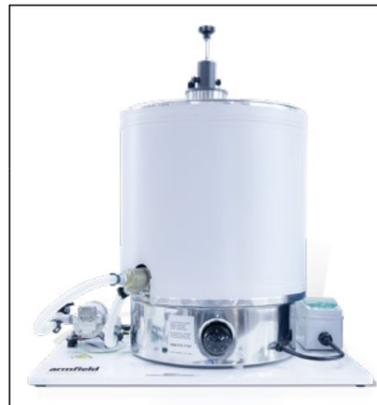
**Instationäre Wärmeübertragung - HT17**
