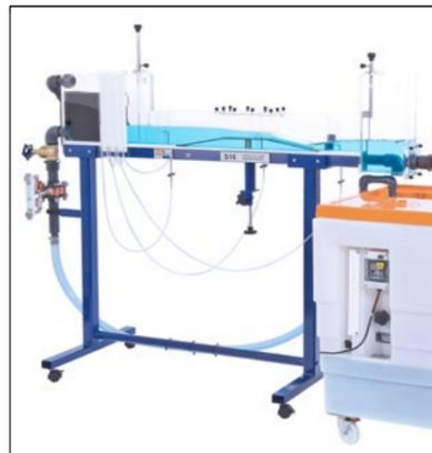
**Demonstrator für hydraulische Strömung - S16**
