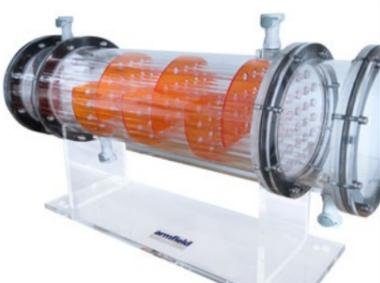
**Eingängiger Wärmetauscher mit festen Rohren - ME301**
